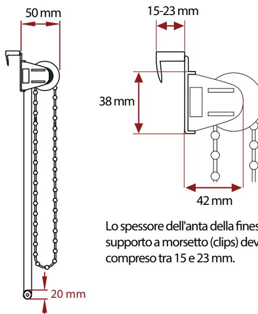
Lo spessore dell'anta della finestra per il supporto a morsetto (clips) deve essere compreso tra 15 e 23 mm.
